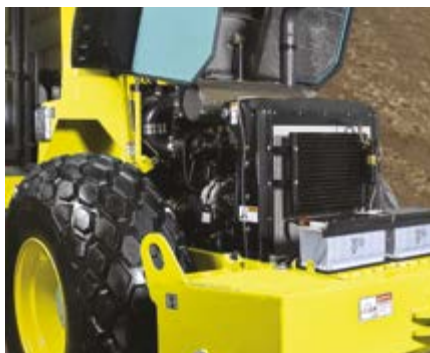
ACESSO AO COMPARTIMENTO DO MOTOR E LOCALIZAÇÃO DA BATERIA
