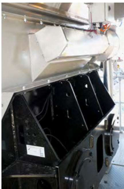
Vista esterna: mescolatore dotato di un generatore di schiuma.
