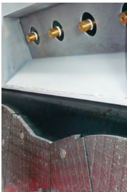
Il bitume schiumato viene immesso nel mescolatore con gli iniettori.
