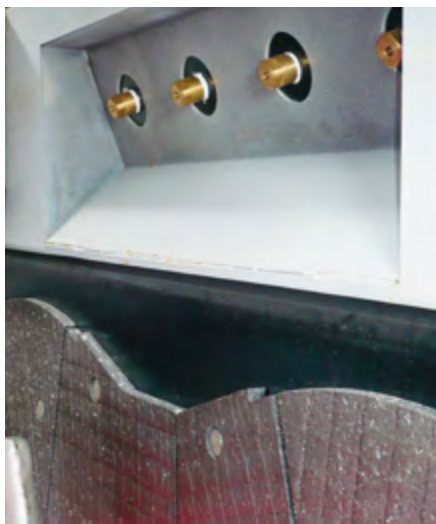
Вспененный битум подается в смеситель с помощью форсунок.
