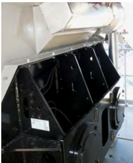
Вид снаружи: смеситель, оснащенный системой вспенивания.
